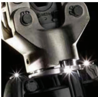
Iluminación de la zona de trabajo mediante 4 luces LED
