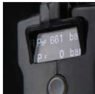
Display OLED multifunción con botón capacitivo táctil
