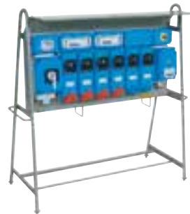
Cuadros ASC para obras sobre caballete con placa inoxidable con bases enclavadas protegidas con magnetotérmico 50-60Hz IP65
